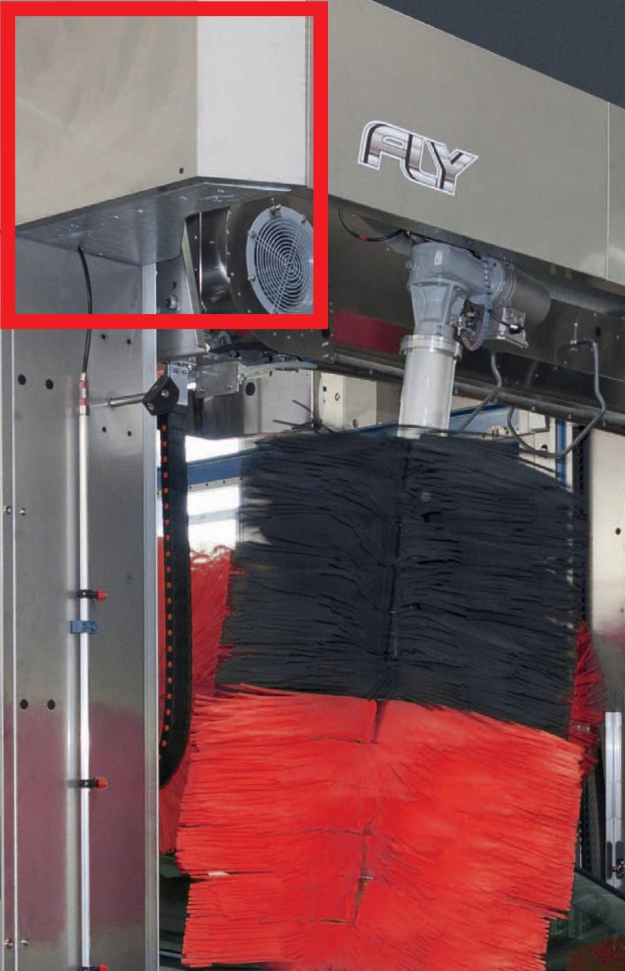
La spalla interna, il piede e tutto il rivestimento esterno della macchina sono realizzati interamente in acciaio inox.
