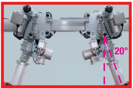
La perfetta adattabilità delle spazzole verticali ai profili laterali del veicolo avviene grazie al dispositivo di inclinazione delle spazzole sino a 20° e alle schede dedicate di assorbimento della corrente.
